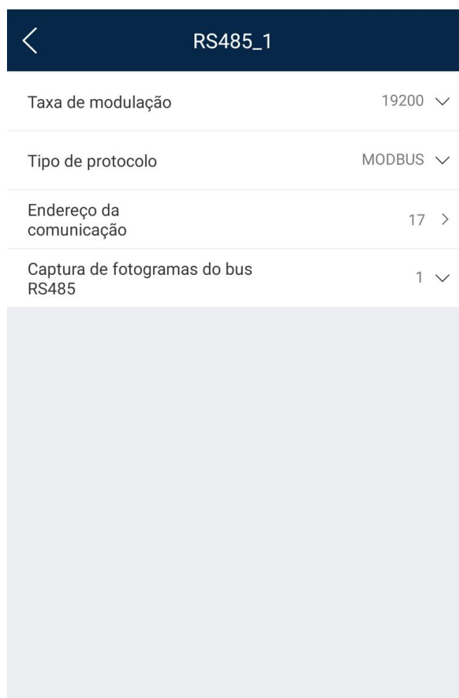
Figura E.1: Interface do aplicativo Fusion Solar para configurar a comunicação Modbus.
